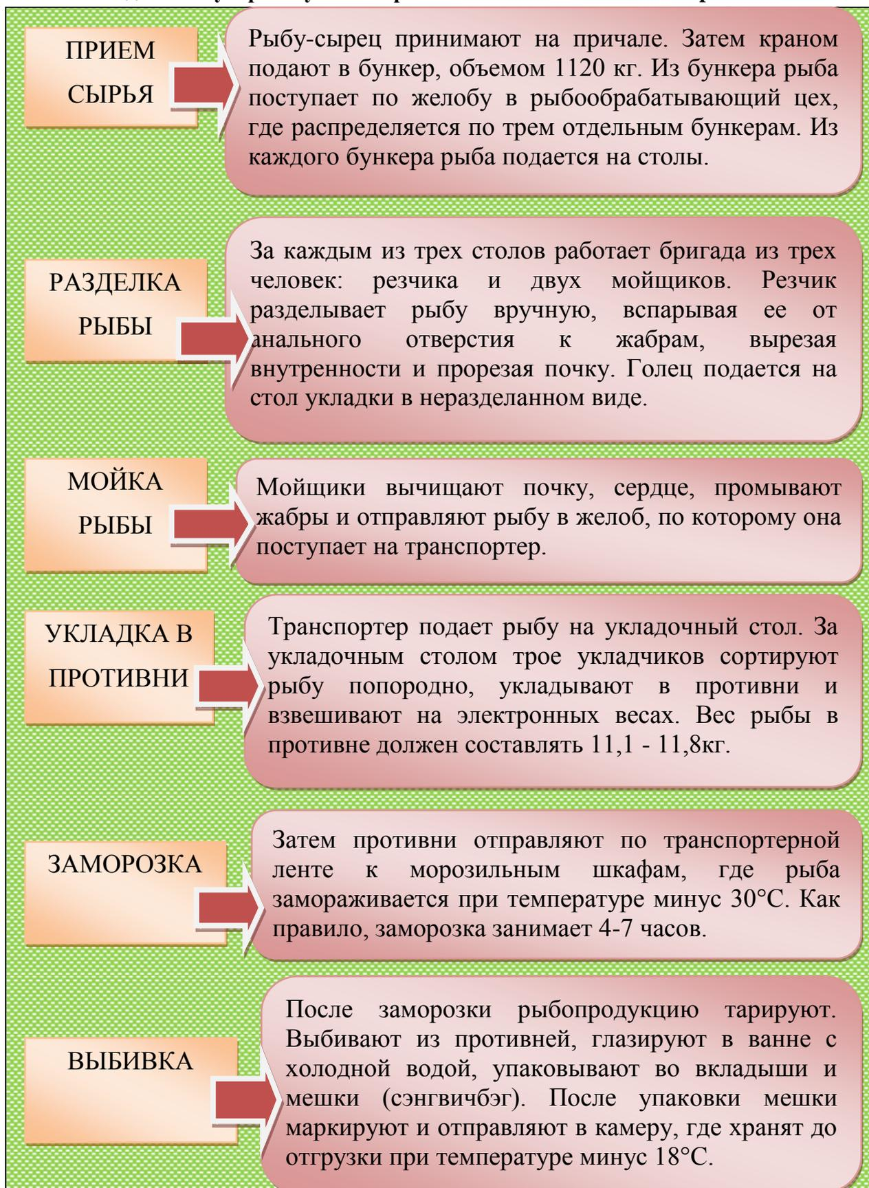
Рис.3.1.1. Технологическая схема производства свежемороженой рыбопродукции на предприятии ООО «Морская планета».
