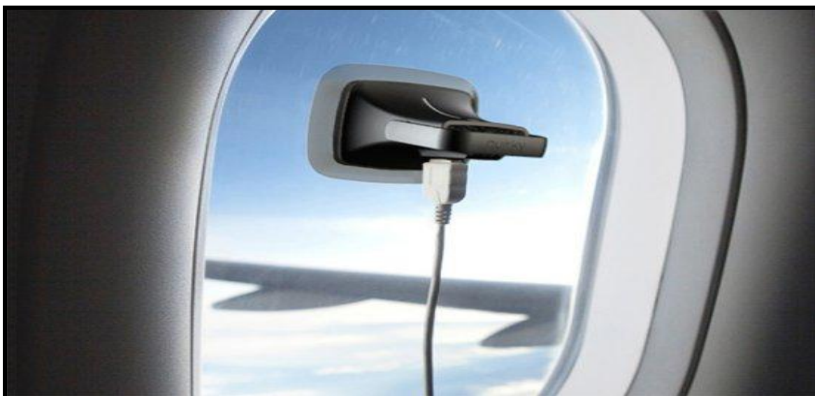
Рис. 1.15. Зарядное устройство на солнечных батареях для сотового телефона Quirky Ray (фото).
