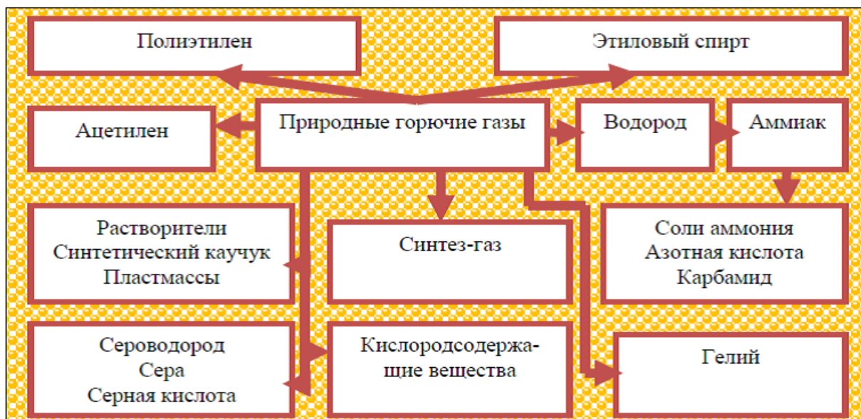
Рисунок 3.1- Важнейшие продукты, получаемые из природного и попутного нефтяного газа
