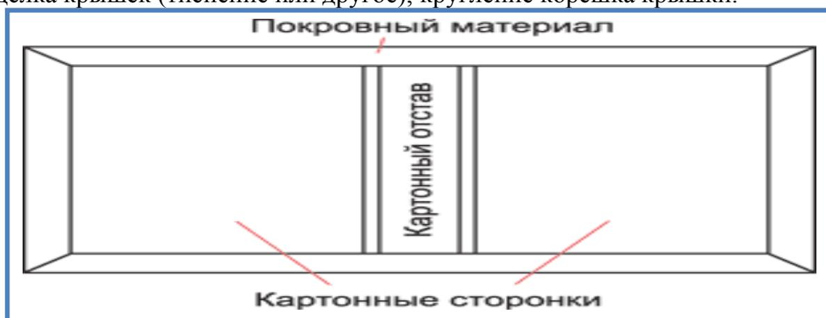
Рисунок 2.5- Конструкция стандартной переплетной крышки.
