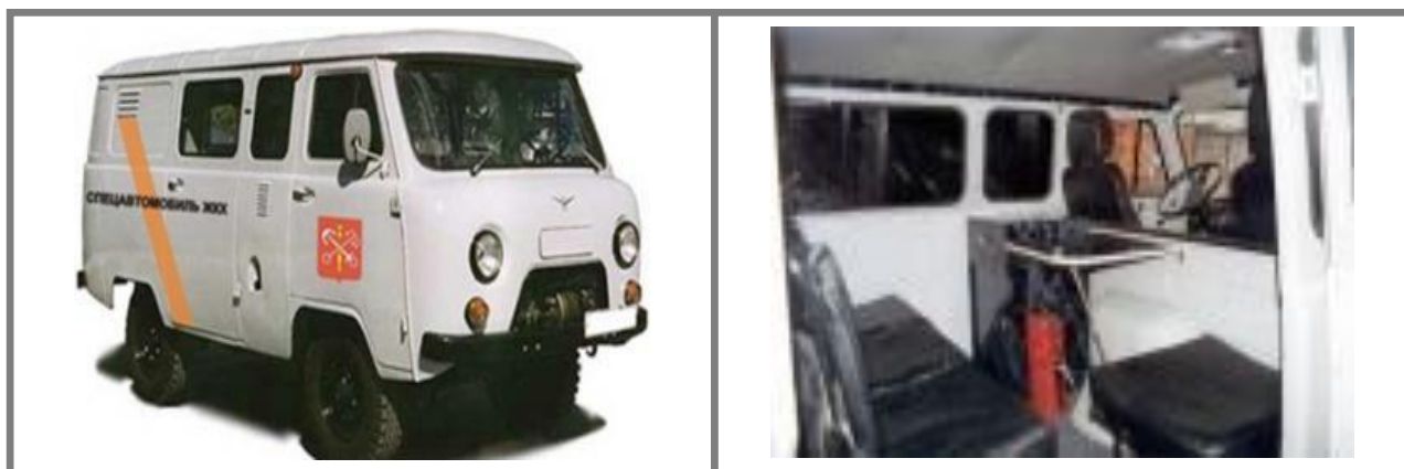
Рис. 5.1.3. Специализированный автомобиль АС-ЖКХ-3У на базе УАЗ-39099.
