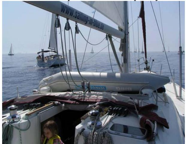
**Гика-шкот** предназначен для установки **Гика** и **Грота** под углом к ветру:
