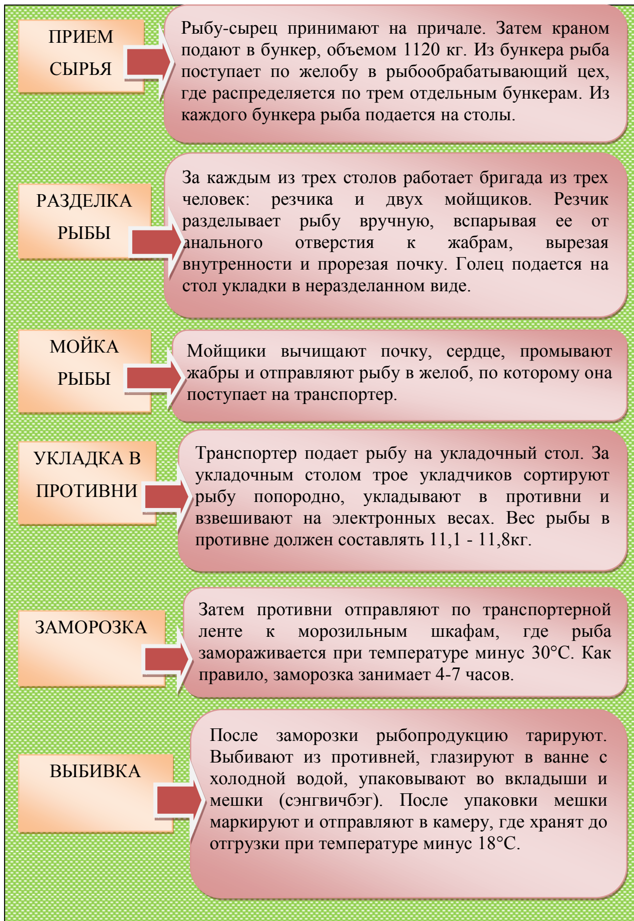
Рис.3.1.1. Технологическая схема производства свежемороженой рыбопродукции на предприятии ООО «Морская планета».
