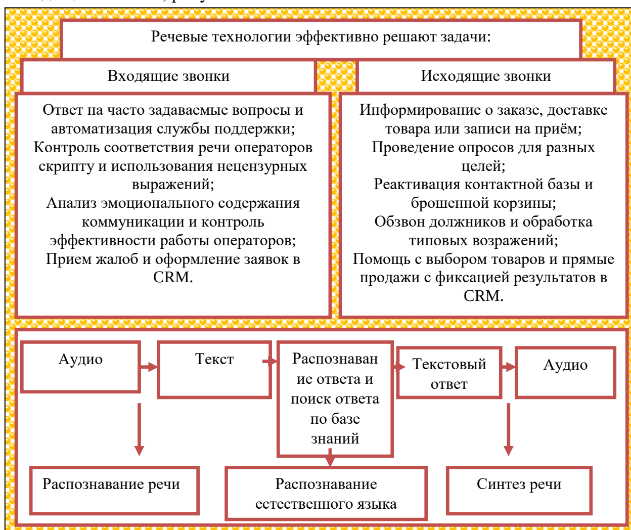
Рисунок 3.3-Решение задач с помощью речевых технологий и схема работы голосового помощника
