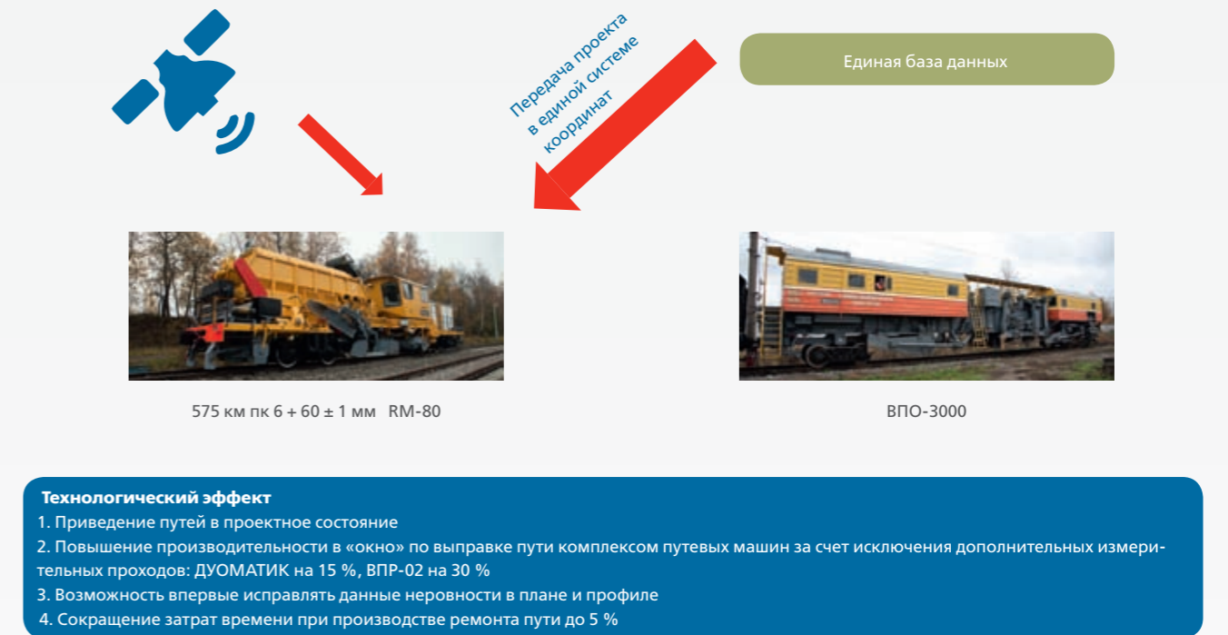
Рис.9.10. Внедрение комплексной системы пространственных данных инфраструктуры железнодорожного транспорта (КСПД ИЖТ) для совершенствования технологии выполнения работ по ремонту пути на основе высокоточной системы координат.
