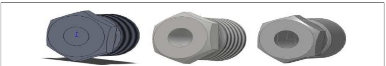
Рисунок 15. Модели детали, сделанные в SolidWorks, Autodesk Inventor и Компас 3D[33] [11]
