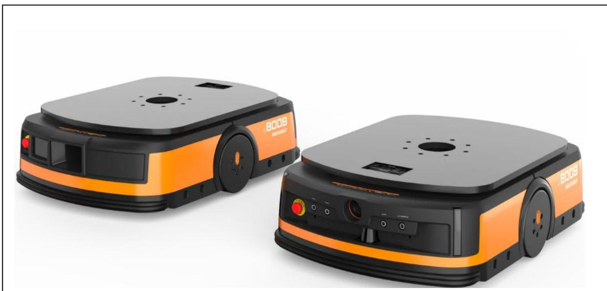
Рис.3.2. Фото робота –транспортировщика НИКРОБОТ[14]
